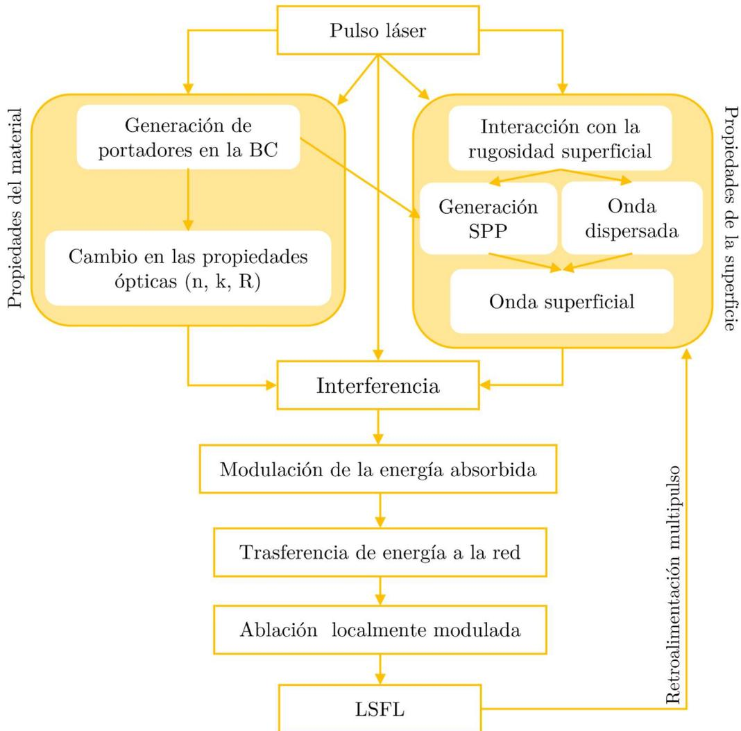
Figura 1.6. Esquema de los procesos involucrados en la generación de LSFL al irradiar un semiconductor con pulsos láser. Esquema adaptado de [60]
